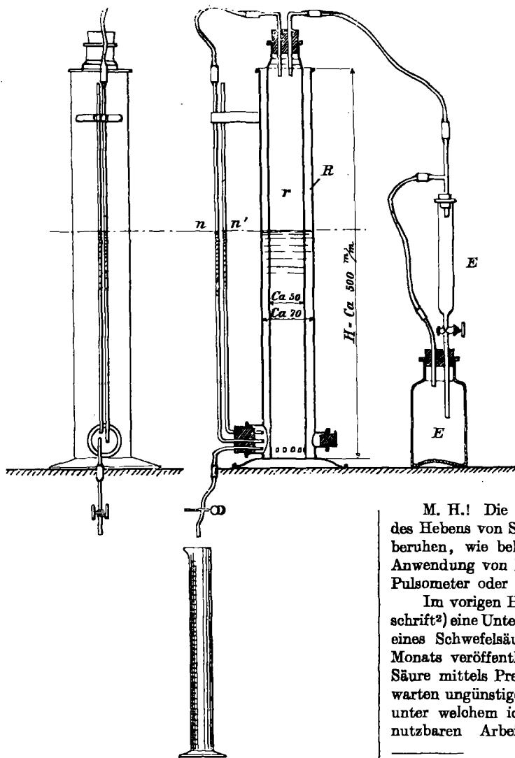
R und r sind durch die in r befindliche untere Lochreihe zwei kommunizierende Rohre, die aus Weißblech gefertigt sein können. Der untere Gummistopfen enthält 3 Bohrungen zur Aufnahme
